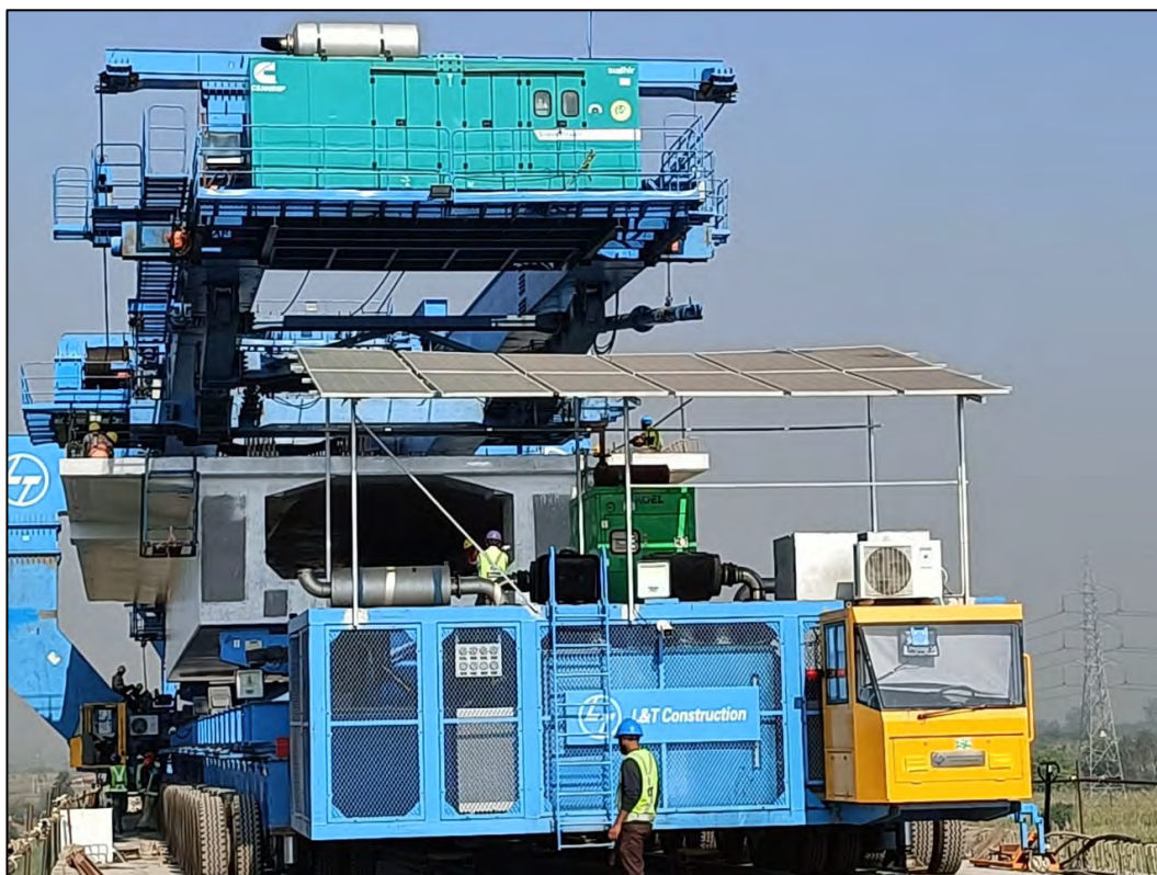
ऑपरेटर्स के बिन के पावर ए/सी के लिए गर्डर ट्रांसपोर्टर पर सोलर पैनल उपलब्ध कराया गया
