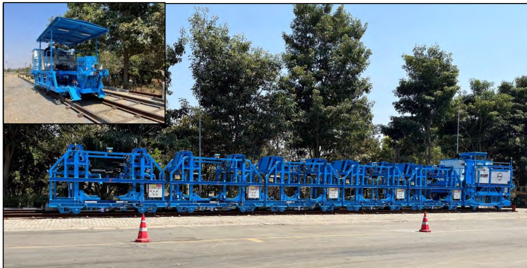
ट्रैक वर्क्स (पैकेज टी 2) - ट्रैक स्लैब बिछाने वाली कार और रेल बिछाने वाली कार (इनसेट में), गुजरात
